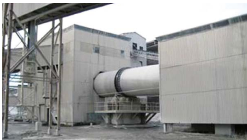
Figura 12. Máquina que seca los núcleos de arena triturados.
