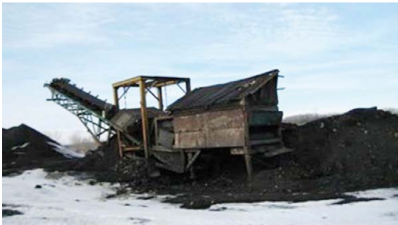
Figura 11. Máquina que tritura y zarandea los núcleos de arena.
