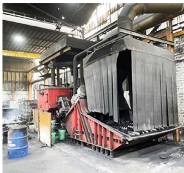
Figura 9. Sistema de recuperación de arenas de moldes.
