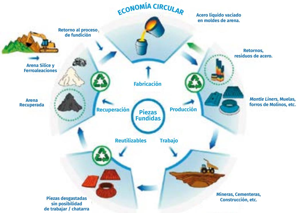
Fuente: fundición ferrosa S.A.C.
