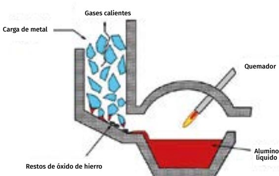
En la superficie del metal fundido se forma una escoria que debe ser eliminada antes de la colada y evitar que llegue al molde, para lo cual se adiciona caliza que reacciona con las impurezas y las funde a baja temperatura para así removerlas. Las escorias conforman un residuo sólido que debe ser adecuadamente dispuesto y en condiciones ambientalmente seguras.
