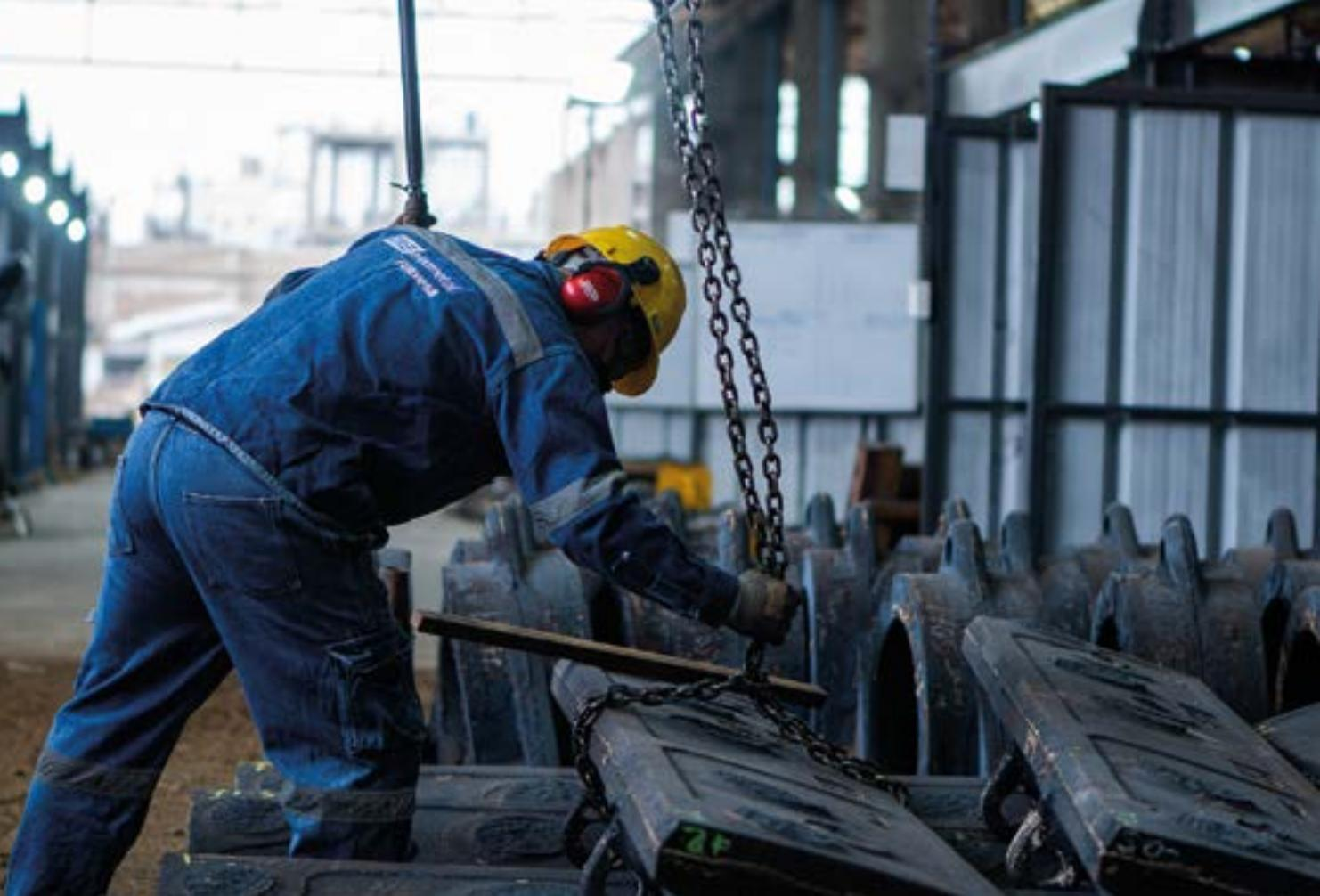
En las fundiciones de acero, los operadores retornan hasta el 60 % de la chatarra interna como máximo en el metal de carga debido al contenido de gas disuelto de dicha chatarra. Las virutas pueden provocar un exceso de oxidación del metal fundido.
