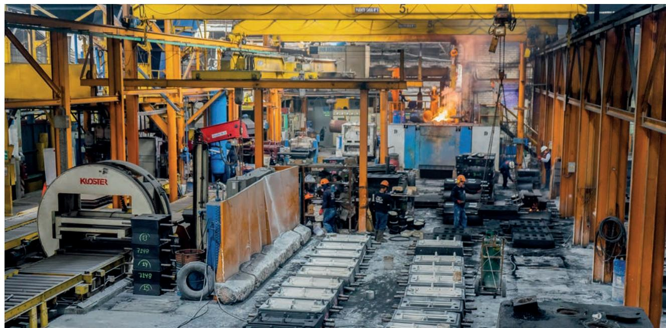
Fundición Ferrosa, fundada en 1967 e iniciada en 1969 con hierro gris y nodular, tuvo como primeras líneas los discos y tambores de freno. Hoy, tras casi seis décadas de especialización, fabrica componentes de desgaste para minería y construcción. Su portafolio incluye piezas en aleaciones de alto desempeño -acero al manganeso, cromo-molibdeno y hierro blanco alto cromo- diseñadas para maximizar resistencia al impacto y la abrasión en operaciones severas.
